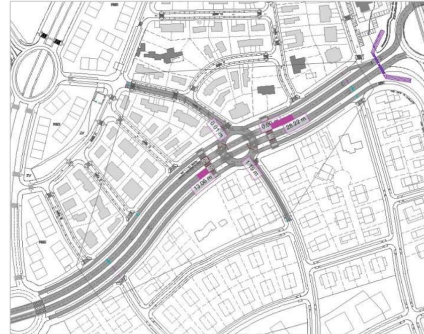
Figura 14. Longitud promedio de las colas para la configuración de glorieta partida. HPT.
