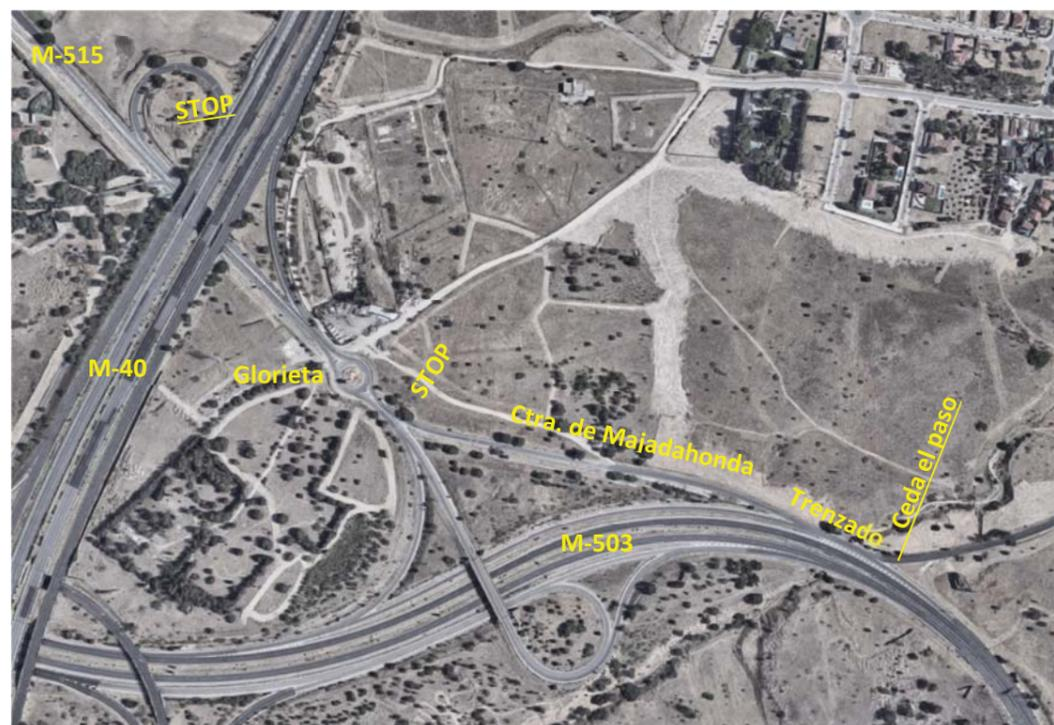
Figura 4. Configuración de las conexiones entre M-503, M-515 y M-40.
