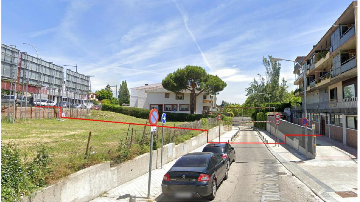
En línea roja se aprecia la sección transversal del terreno y cómo el camino de Valdenigrales se desarrolla en "trinchera", manteniendo por encima de su rasante el terreno natural de las parcelas a ambos lados de la calle. La sección siguiente muestra este corte:
