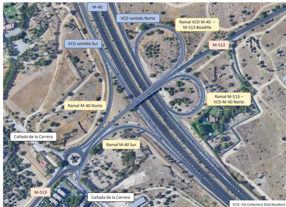
La solución propuesta amplía la sección de la M-513, dotando de dos carriles por sentido en el paso superior sobre la M-40, ampliando la calzada anular de la glorieta situada entre la intersección de la M-513 y la Cañada de la Carrera a tres carriles; que contará con una sección en bulvar de dos carriles por sentido. Dicha glorieta deberá canalizar los movimientos entre la Vía Colectora Distribuidora de la M-40 en sentido sur y la M-513 sentido Pozuelo.
