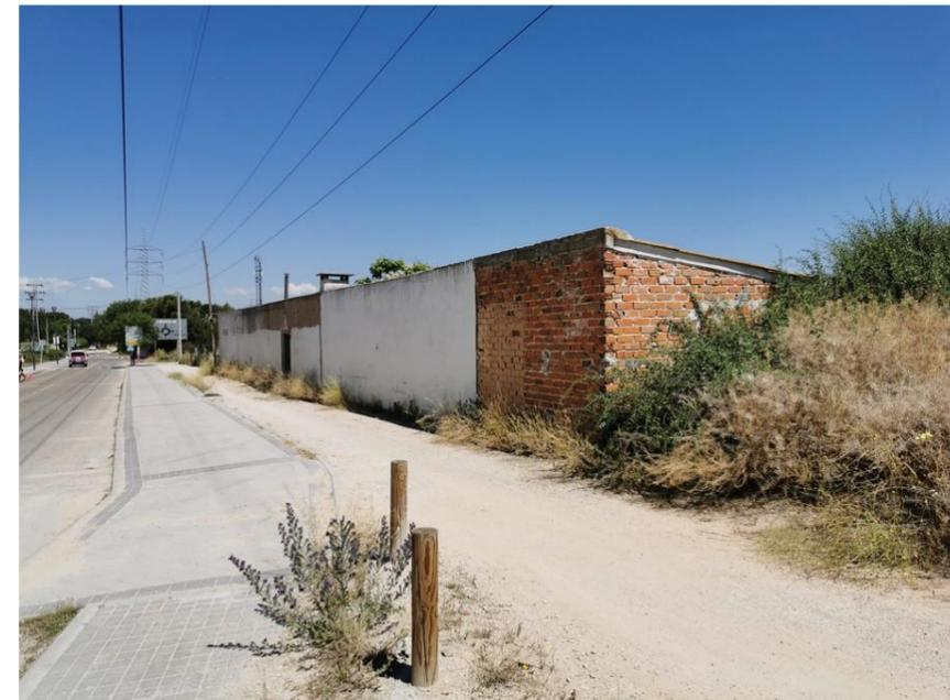
Se observa el tendido aéreo de alta tensión que sobrevuela parte de esta edificación. Se tomarán las medidas de protección para no acercarse a dicho tendido. Esta edificación se demolerá a mano, elemento a elemento, o con maquinaria de menos de 4 metros de altura total.
