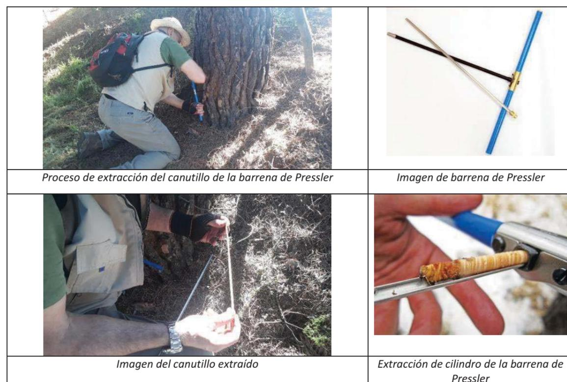
Figura 1. Imágenes del proceso de barrenado
