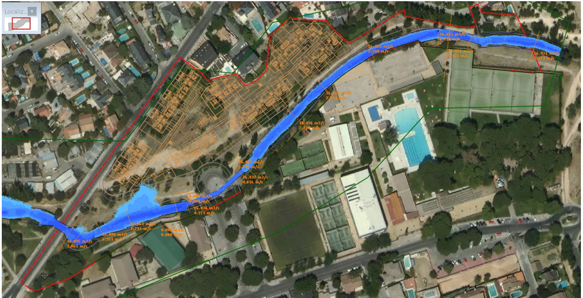
Vista general de la zona de afección de avenida para Q 25 actual. En rojo, el límite de la parcela
