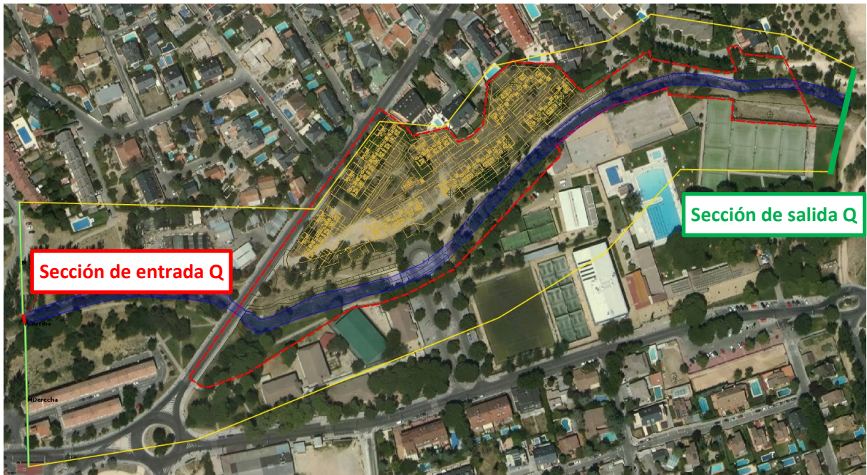
Secciones de entrada y de salida de caudales al Arroyo Pozuelo
