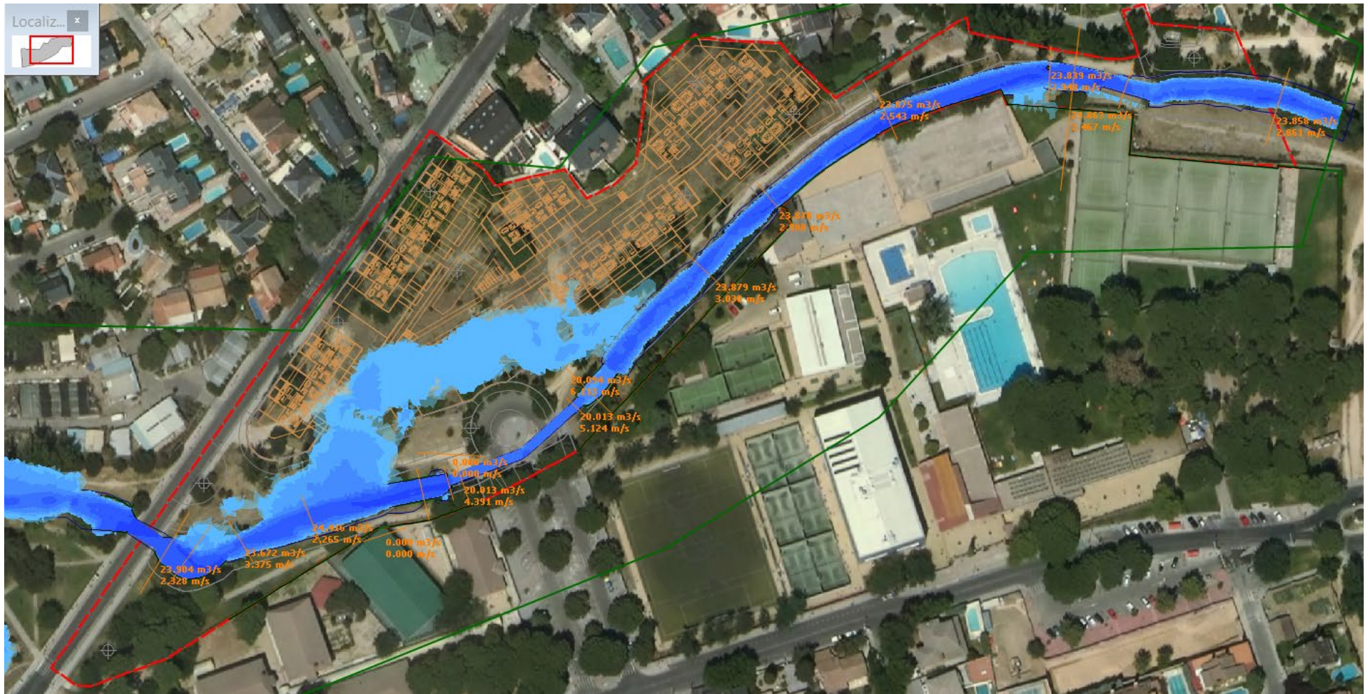
Vista general de la zona de afección de avenida para Q 100 actual. En rojo, el límite de la parcela
