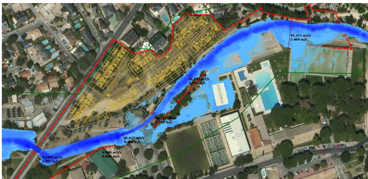
Resultados de Inundación Máxima para T=500 años en situación futura ( Q=43.8 \text{ m}^3/\text{s} )
