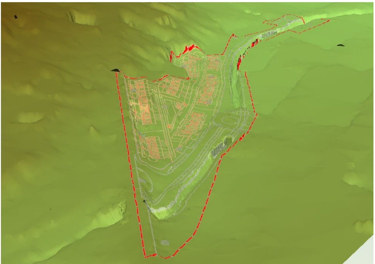
Vista 3D en dirección O-E de la parcela sobre el modelo digital del terreno, apreciándose el cauce del Arroyo Pozuelo en la parte sur de la parcela. Exageración Vertical 5:1
