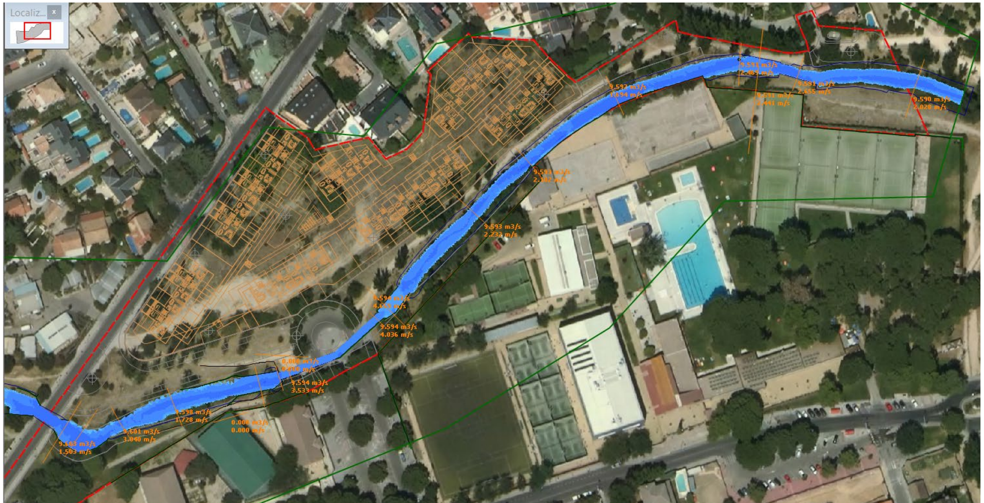
Vista general de la zona de afección de avenida para Q_{10} futuro definitivo. En rojo, el límite de la parcela
